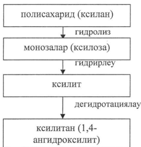
1 сурет - Полисахаридтен ксилитанды алудың негізгі үш химиялық реакциясының тізбегі
