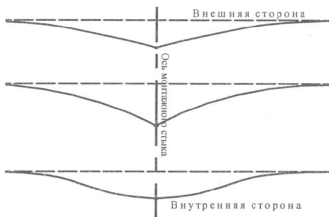
Рисунок 2 - Характерные формы начальных искривлений стенок резервуара в зоне монтажного соединения
