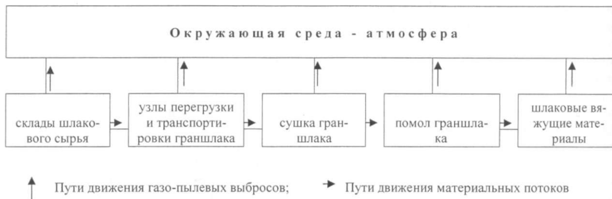
Рисунок 1 - Схема взаимодействия в геотехнической системе «производство – окружающая среда»
