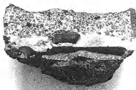
Рисунок 4 - Фотография разреза тигля при электроплавке шихты, состоящей из 88,6% клинкера, 9,6% кварцита, 1,8% кокса
